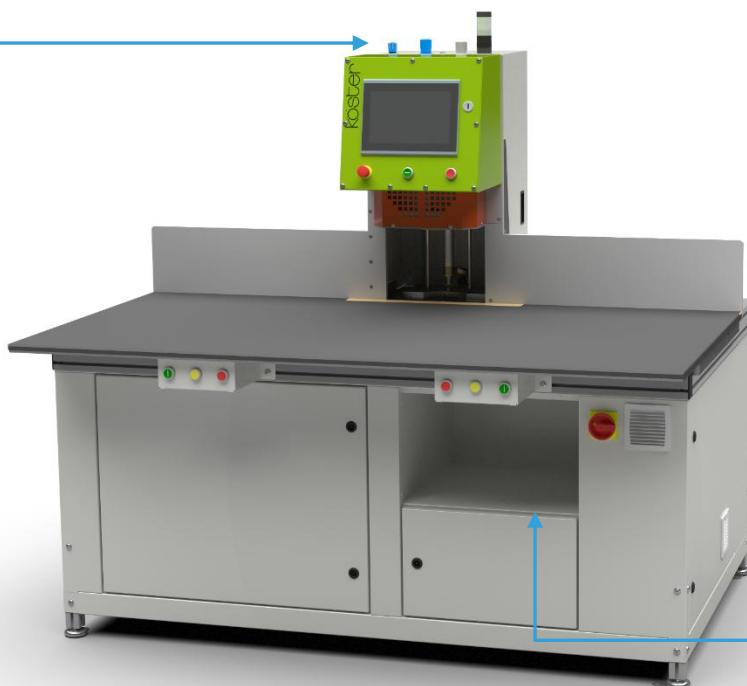
Espace dans le châssis de la machine pour l'installation d'une imprimante.
